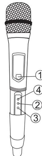
1. Bouton d'alimentation : une pression longue permet d'allumer ou d'éteindre le microphone. Double-cliquez pour mettre le microphone en sourdine ou pour l'activer.
